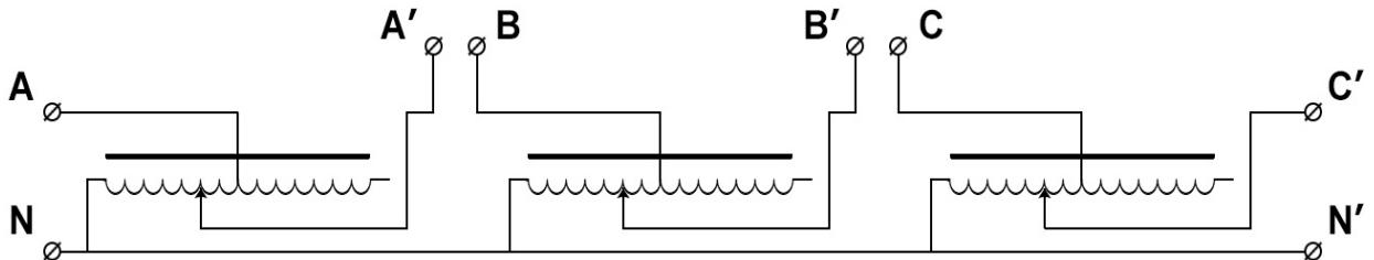
Регулирование напряжения осуществляется за счет изменения коэффициента трансформации. При перемещении графитовой щетки по обмотке автотрансформатора изменяется коэффициент трансформации и, как следствие, выходное напряжение. При коэффициенте трансформации, равном 1, вся электрическая энергия из сети передается в нагрузку.
