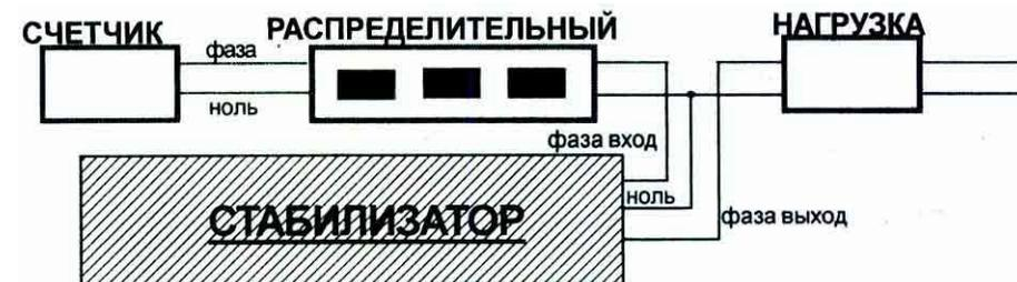
для стабилизаторов мощностью 3 – 12 кВт: синий – ноль, коричневый - фаза вход, черный – нагрузка, зелено-желтый — заземление; для стабилизаторов мощностью 15 – 20кВт на концах проводов нанесена маркировка.
